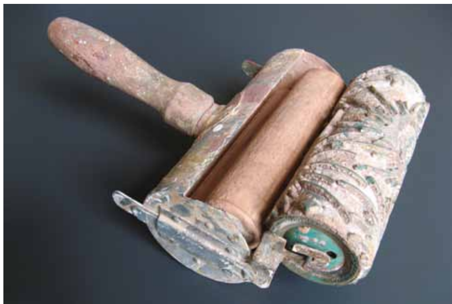
Valjni aparat z magazinom za barvo in vzorčnim valjčkom; po drugi svetovni vojni (foto Andrej Dular).
